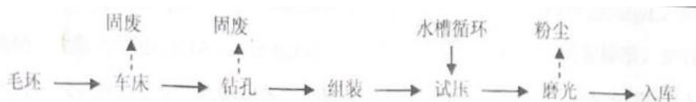
图 2-5 现有项目生产工艺流程图
