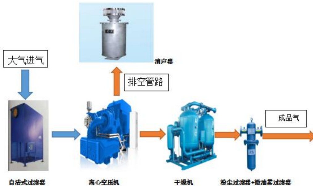
图 4-2 离心式空压机空气压缩系统工艺流程图
