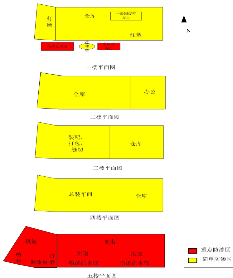
图 4-2 项目厂区地下水污染防渗分区图
