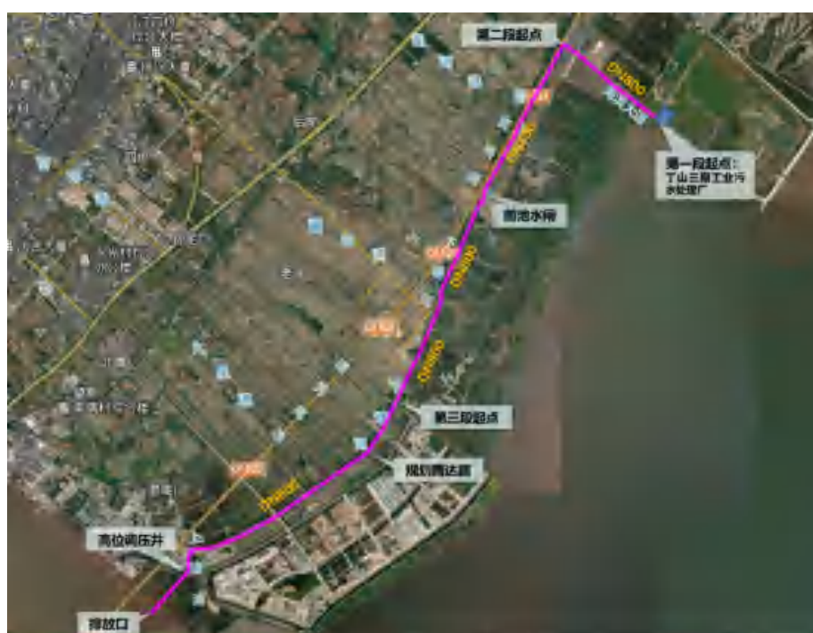
图 3.2-3 尾水排放管道平面布置
