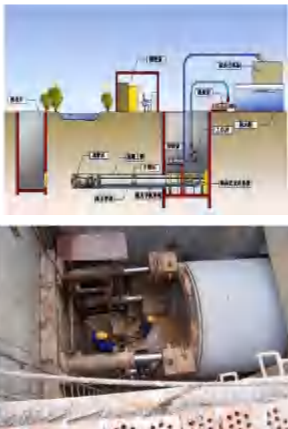
图 3.2-10 泥水平衡机械顶管
