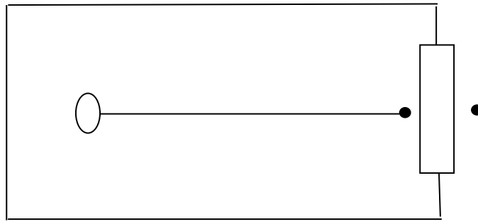
图 4.2.3-1 室内声源等效为室外声源图例
