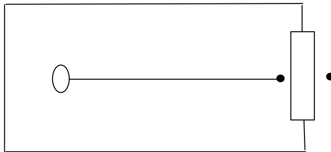
图 4.2.3-1 室内声源等效为室外声源图例
